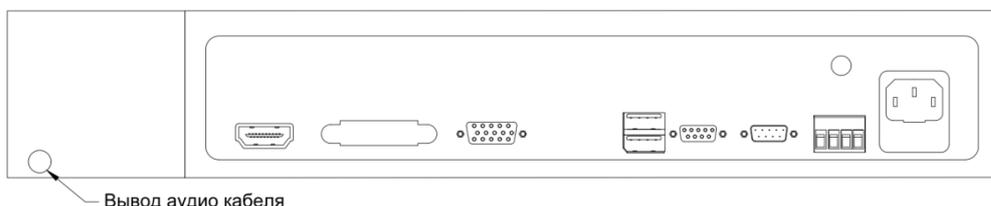
**1.3.1** На схеме изображена задняя панель вывода кабеля с микрофонного лифта с учетом использования конгресс-систем Bosch.
